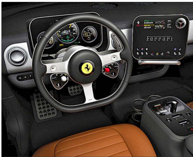
DE VIDEOJUEGO. El interior del Luce no es el de un Ferrari conocido, pero es más admisible que la carrocería. Tiene dos pantallas. La que está por detrás del volante se desplaza con éste y con la central, que también se puede mover en el eje horizontal como en el vertical.
